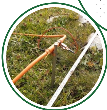
Sonde et câble ERT
