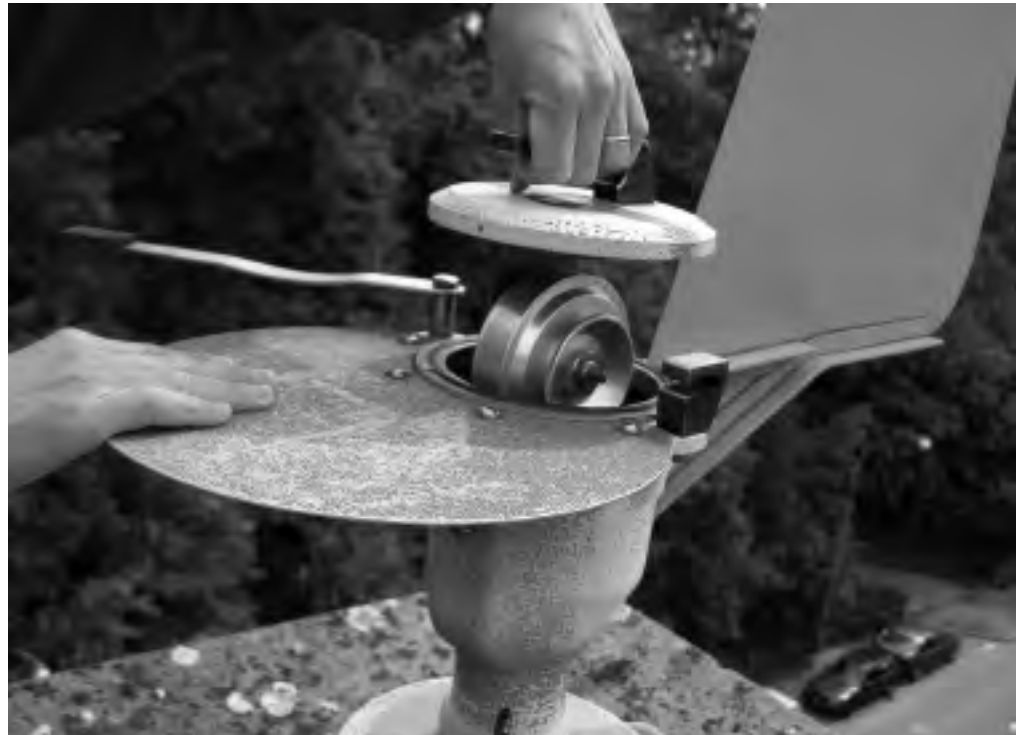
L'aspirateur à pollens est installé sur le toit de l'Institut de chimie.
