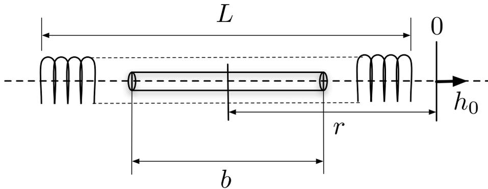
La composante  $h_0$  du champ induit est fonction des paramètres de la bobine, du barreau et du champ induit  $h$  dans le noyau ferromagnétique :
