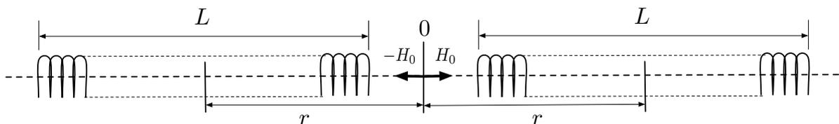
Un barreau ferromagnétique (longueur  $b$ , rayon  $R$ ) est alors introduit au centre de l’une des bobines ; le champ magnétique mesuré au point 0 est le champ  $h_0$  produit par le barreau.
