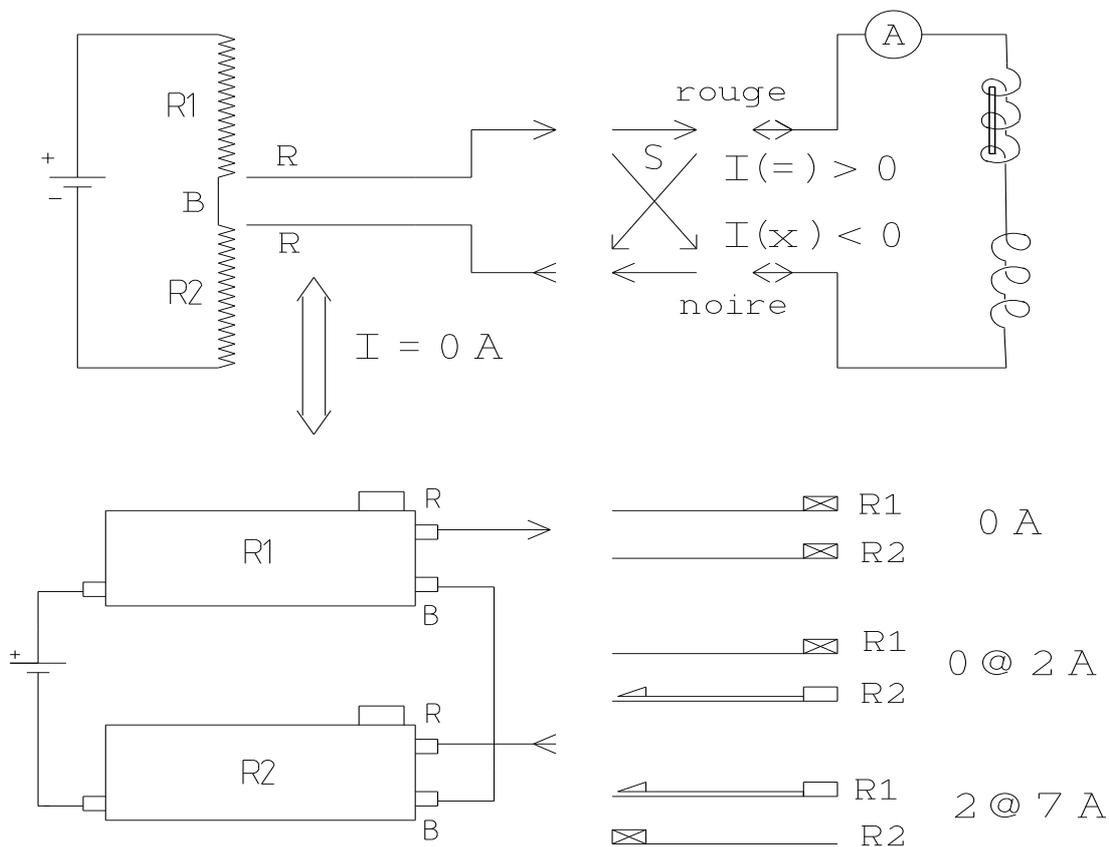
FIG. 2 – Schéma électrique.
